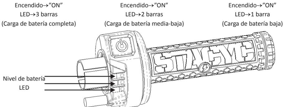
6. Si sigue girando el acelerador (+10 %), se activará el motor. Cuanto más se gire el acelerador, más potencia se alimentará al motor, según el programa de potencia seleccionado.
